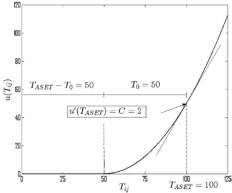
$$\text{E.g.: } u(T_{ij}) = \begin{cases} 0, & \text{if } T_{ij} < T_{ASET} - T_0, \\ \frac{C}{2T_0} (T_{ij} - T_{ASET} + T_0)^2, & \text{if } T_{ij} > T_{ASET} - T_0. \end{cases}$$
