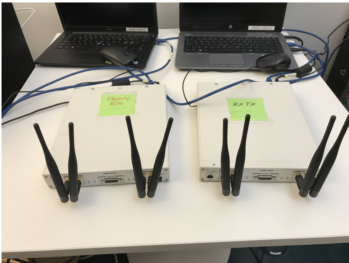
Kuva 1: Yllä on kuvattu käytetty MIMO-järjestelmä. Vasemmanpuoleinen ohjelmistoradio vastaa taulukon 1 laitetta B ja oikeanpuoleinen laitetta A. Ohjelmistoradiot on yhdistetty sinisin Ethernet-kaapelein kuvan yläosan kannettaviin tietokoneisiin. Kuva: Maarit Melvasalo
