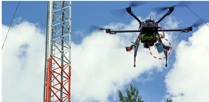
Kuva 6: Puhelin kiinnitettynä kopterin laskutelineeseen [10]
